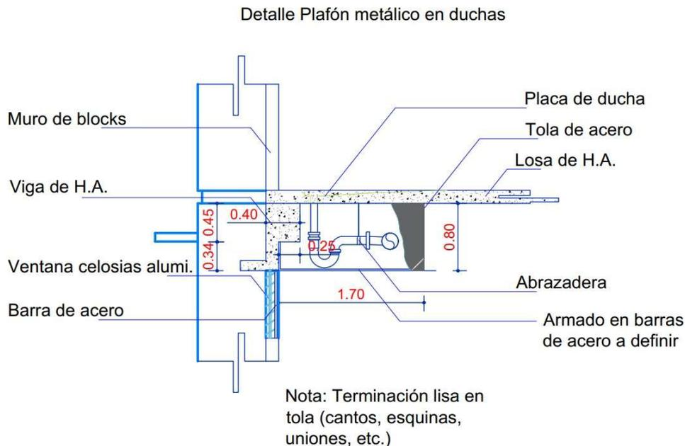
Esta estructura debe poseer aberturas de puertas donde se pueda acceder a las tuberías para realizar mantenimiento a las mismas.
