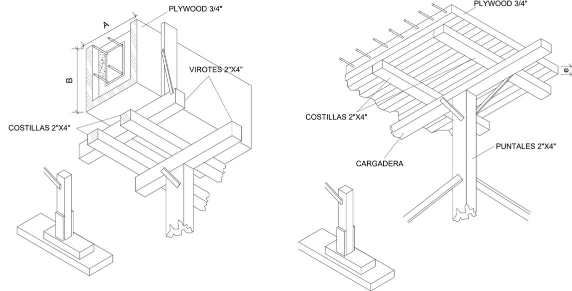
**DETALLES ENCOFRADO COLUMNAS**
