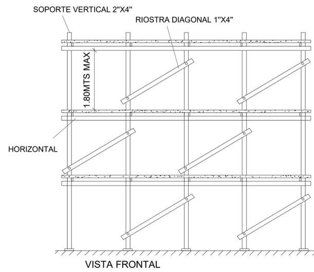
**REQUISITOS MINIMOS DE CONSTRUCCIONES PARA ENCOFRADOS DE LOSAS**
